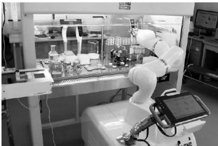
自動で細胞を培養するラボ・ベンチロボット
